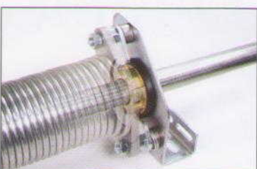
Le dispositif de protection contre le bris des ressorts, offert en option, empêche la porte de chuter sur plus de 30,5 cm (1 pi) en cas de défaillance du contrepois.
