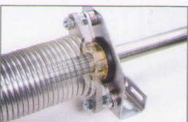
Le dispositif de protection contre le bris des ressorts, offert en option, empêche la porte de chuter sur plus d'un pied en cas de défaillance du contrepoids.
