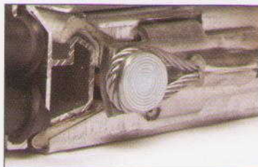
Le câble ne peut être relâché lorsqu'il est sous tension, évitant ainsi tous accidents.
